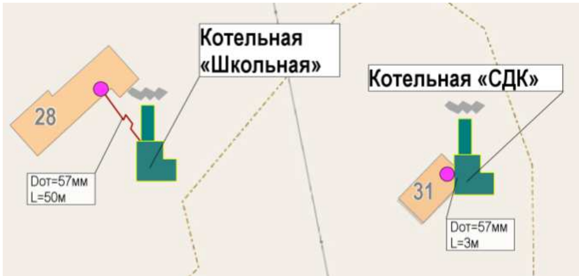
Рис. 1.2. Существующая схема тепловых сетей в зоне действия децентрализованных источников тепловой энергии Elizavetinskoye сельсовета Mokshan district Пензенской области.
